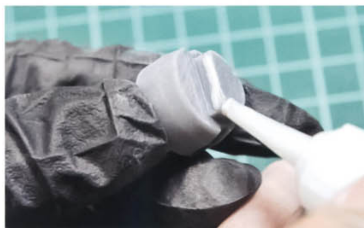
07 出力物は、たまにひけ(へこみ)が発生し、合わせがプカプカになることがあります。シアノン瞬間接着剤でダボに厚みをつけたら、瞬間硬化剤で硬化させます。
