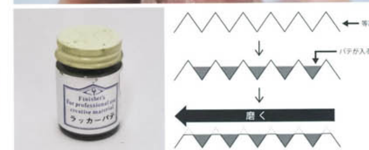
POINT このようにパテを薄く全体に塗ることで、簡単にみがき上げることができます。
