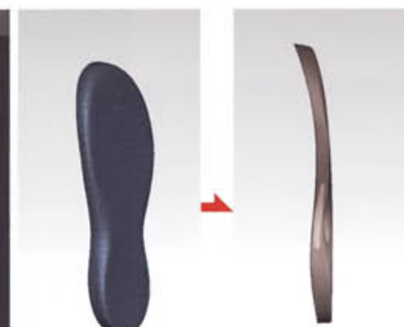
05 Unflatten で形を戻したら、Divide を 2、3 回行います。次に、ポリゴンの密度を上げたら Zremesher する前の複製済みの靴底を表示して、ProjectAll で形状をプロジェクトします。
