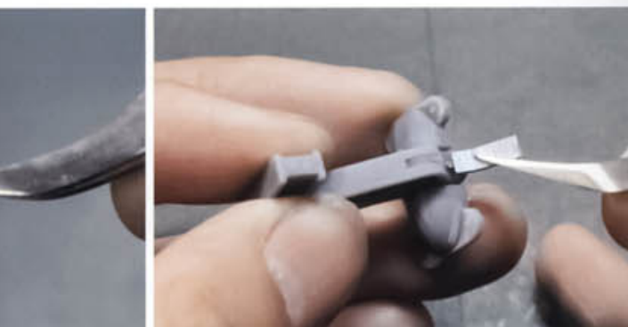
08 細かい入り組んだパーツなどは、小さくカットした紙ヤスリをピンセットでつまみながらじっくりみがいていきます。この作業は320~400番の紙ヤスリを使います。
