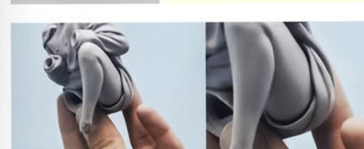
14 だいたいピタッとはまりましたが、たまにひけが大きく、パーツ同士の隙間が目立つことがあります。今回はデータのミスで大きい隙間ができてしまいました。その場合ポリパテを盛って隙間を埋めます。
