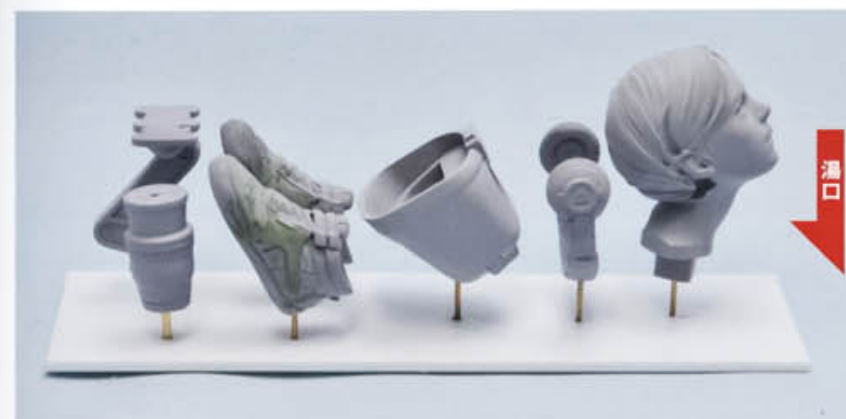
02 プラ板をカットしてそこに真鍮線を立てていきます。下が湯口になるので、キャストを流したときに気泡が入らないような角度を想像しながら立てていきます。
