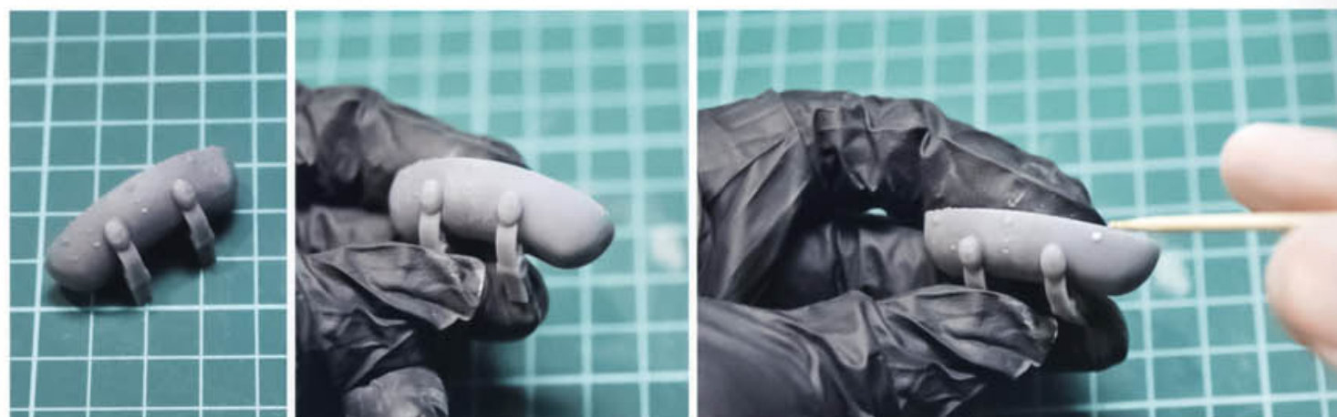
09 このパーツなどはリベットのモールドのまわりにサポート跡があるので、リベットを避けてみがくのは面倒です。リベットもみがきとってしまっ、シアノンをちゃんと乗せて硬化させることでモールドを復元します。
