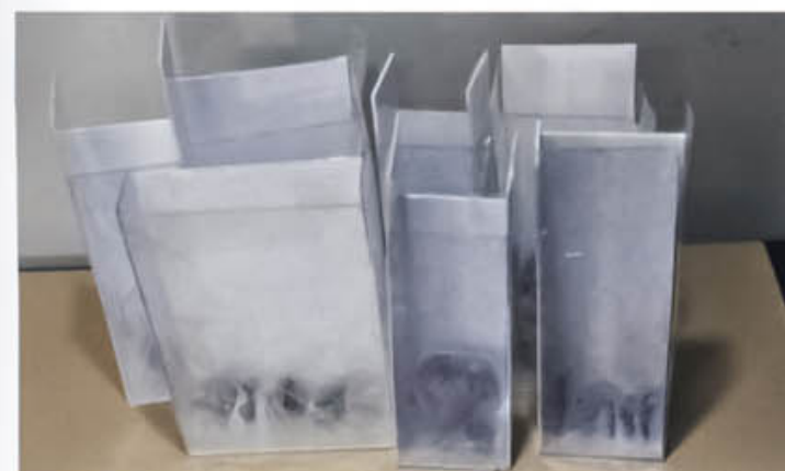
04 プラ板で壁を作り、透明シリコンを流します。
