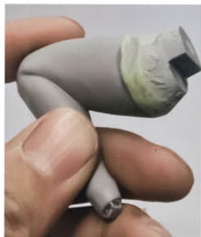
18 硬化したら引き抜き、彫刻刀などで形を整え再びみがきます。これで隙間なく嵌合（かんごう）が作れます。
