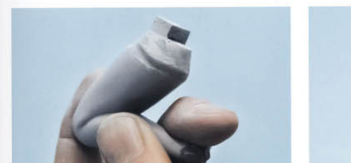
15 盛る側は粗目のヤスリで食いつきをよくするために荒らします。
