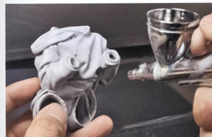
12 Mr.サーフェイサーの1000番をシンナーで2倍ほどに希釈し、エアブラシでサーフェイサーを吹きつけます。
