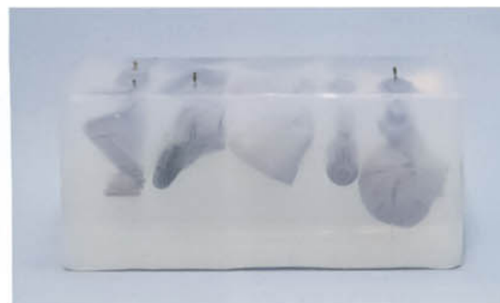
05 透明シリコンを流したら真空脱泡機で脱泡します。
