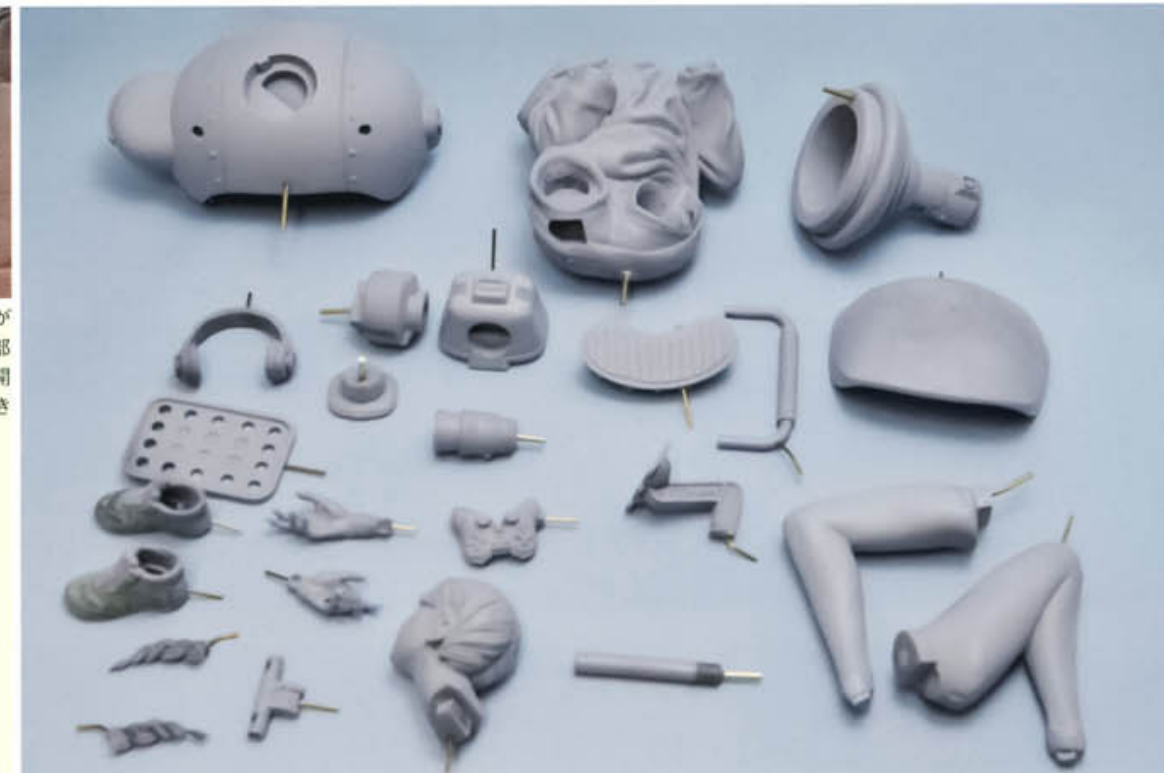
01 パーツごとに、キャストが流れる湯口に当たる部分にピンバイスで穴を開け、真鍮線を刺していきます。
