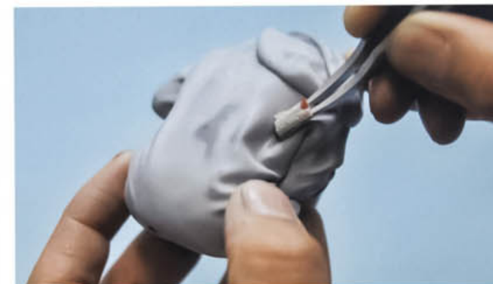
11 みがきづらいへこみなどはスポンジヤスリをピンセットで持ち、みがきます。
