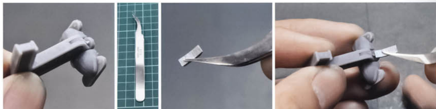
08 細かい入り組んだパーツなどは、小さくカットした紙ヤスリをピンセットでつまみながらじっくりみがいていきます。この作業は320~400番の紙ヤスリを使います。
