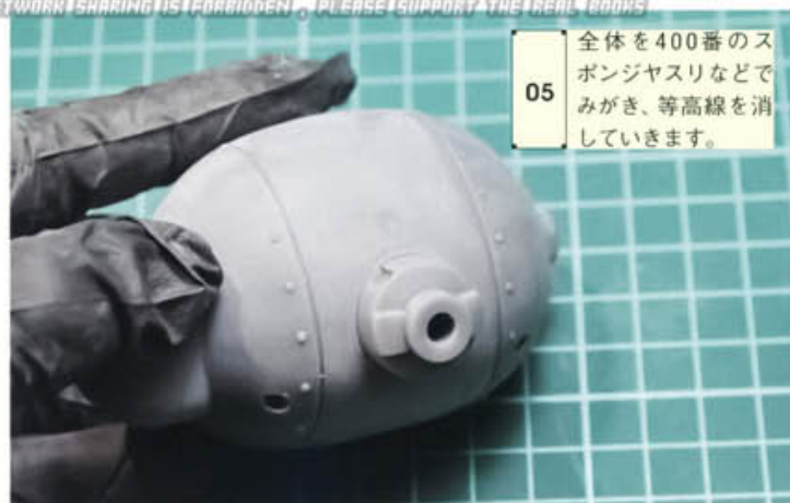
04 SLA方式にかかわらず、3Dプリンタには多かれ少なかれ出力の縦軸(Z軸)方向に等高線が入ってしまいます。それをみがく作業が必須になります。
