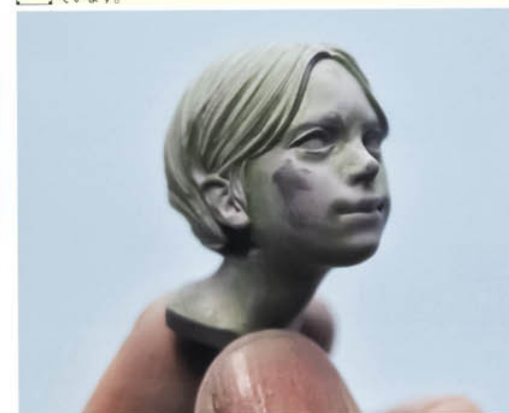
13 ある程度みがいたら、フィニッシャーズのラッカーパテを筆で塗り、乾いたらまたみがいていきましょう。フィニッシャーズのラッカーパテは粒子が細かいので、このような小さいモデルにもモールドがつぶれず、よく使っています。
