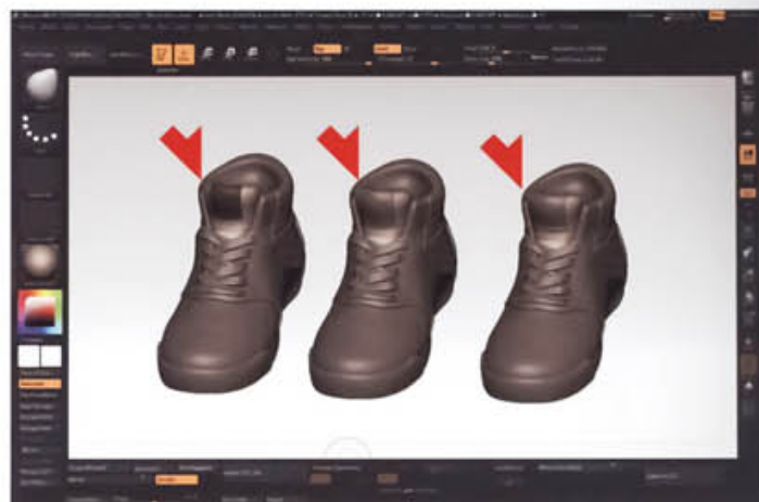
12 マスクして Extract。SK_Slash2 でモールドを入れます。
