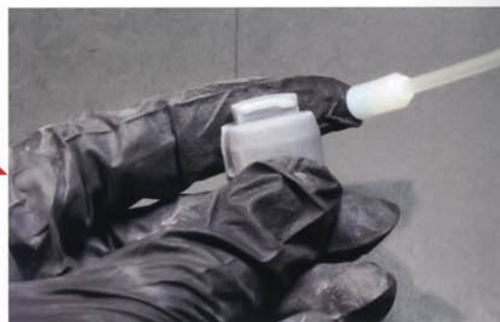
07 出力物は、たまにひけ(へこみ)が発生し、合わせがプカプカになることがあります。シアノン瞬間接着剤でダボに厚みをつけたら、瞬間硬化剤で硬化させます。
