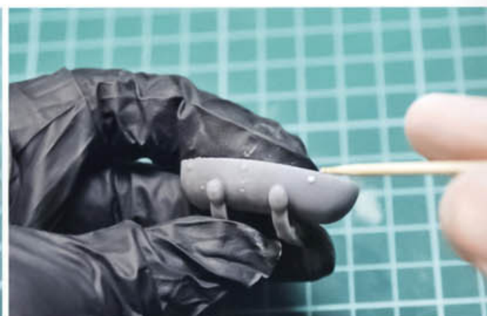
09 このパーツなどはリベットのモールドのまわりにサポート跡があるので、リベットを避けてみがくのは面倒です。リベットもみがきとってしまっ、シアノンをちゃんと乗せて硬化させることでモールドを復元します。
