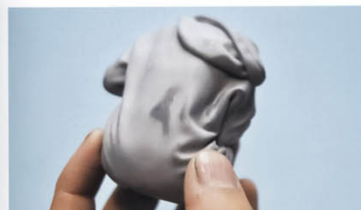
10 基本的にみがいてサーフェイサーを吹いて、まだ等高線が見えるようならそこをみがいて、の繰り返しです。
