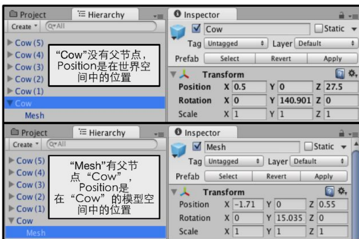
▲图 4.33 Unity 的 Transform 属性。Transform 的 Position 属性指向 "Mesh" 的 Position 属性。"Cow" 的 Position 属性指向 "Cow" 的 Position 属性。
