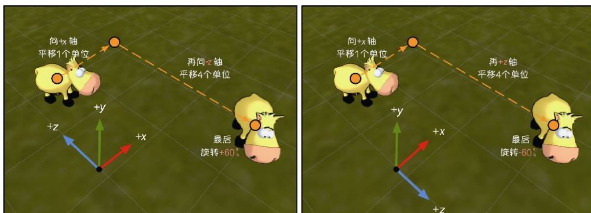
▲图4.11 从初始位置开始，先沿x轴方向平移1个单位，再沿z轴方向平移4个单位，最后沿z轴方向旋转-60°
