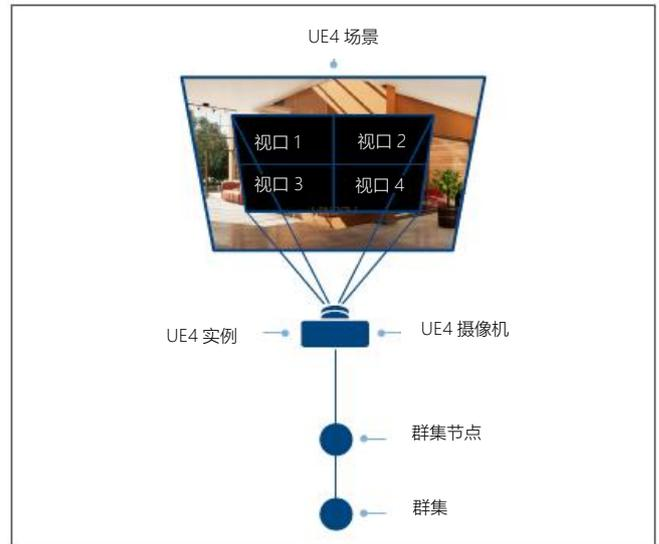
图 16: 窗口、视口、实例、摄像机和群集节点在采用单个群集节点的 nDisplay 系统中的相互关系。
