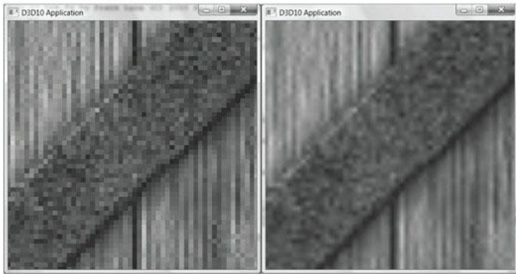
图 8.7 我们在一个立方体放大一幅板条箱纹理，使倍增问题出现。左图使用常量插值，可以看到它产生了明显的斑块；这很容易理解，因为插值函数是离散的（图 8.5a），它所形成的颜色过渡显得生硬而不平滑。右图使用线性插值，由于插值函数是连续的，所以它产生的图像较为平滑。
