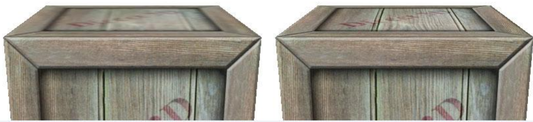
图 8.9 板条箱的顶面几乎垂直于观察窗口。(左图) 使用线性过滤, 板条箱的顶面显得极其模糊。(右图) 在同样的角度上, 使用各向异性过滤得到的渲染结果要好很多。
