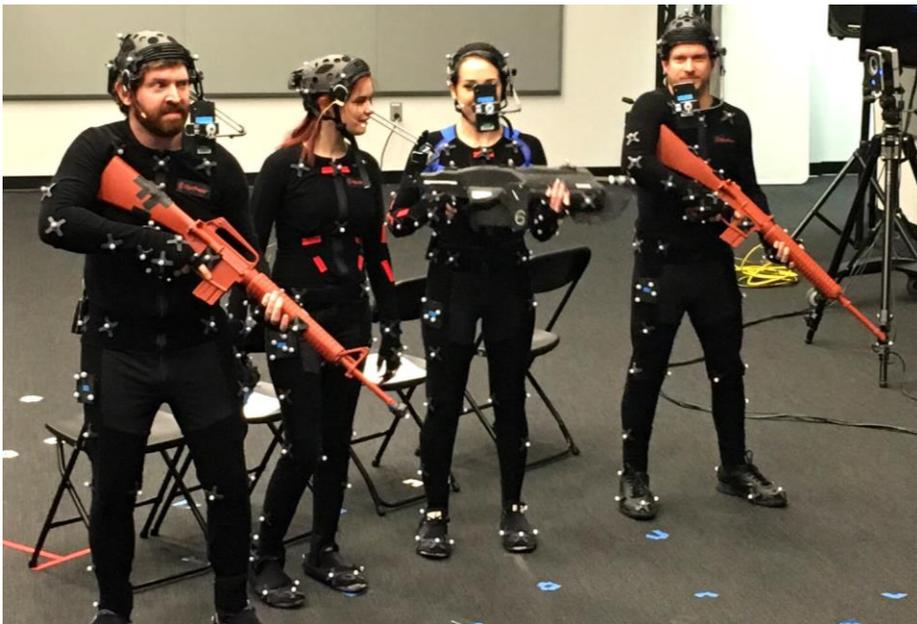
图 2：采用被动标记的光学动作捕捉套装，用于[Epic 虚拟制片技术演示](#)
