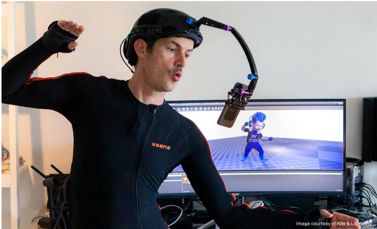
图 15: 用 iPhone X 作为摄像机实现基于图像的面部捕捉。
