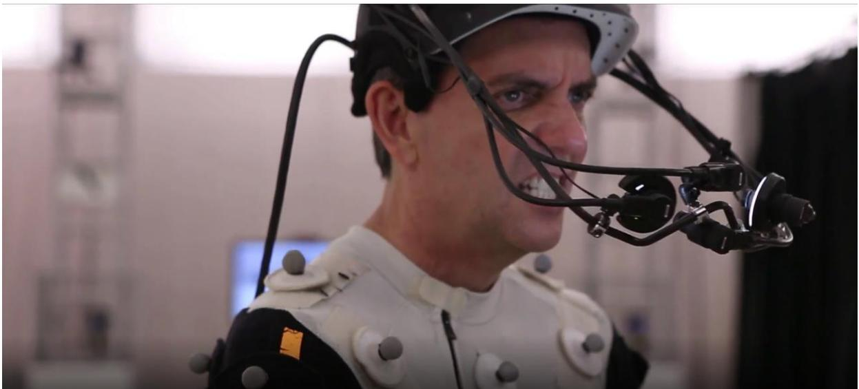
图 12: Digital Domain 的 Doug Roble 正在使用头戴式摄像机进行面部捕捉
