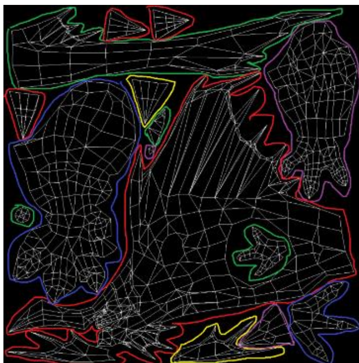
图13.1 为了不破坏UV的拓扑结构，减面的时候都会在轮廓里面完成
