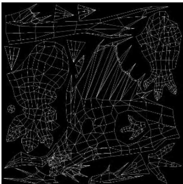
图12.16 把低模平铺在2D空间，这个时候每个顶点的UV值已经确定
